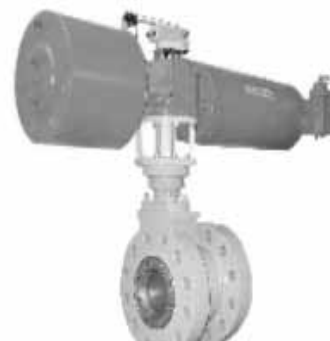
Visokotlačna loputa tipa Leusch LTR 43, ohišje z dvojno prirobnico NPS 10, Class 1500 s pnevmatskim pogonom in regulatorjem položaja
