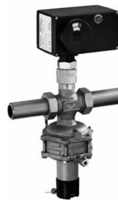
Regulator volumnskega pretoka in diferenčnega tlaka tipa 2487, izvedba DN 32 do 50, zahtevana vrednost diferenčnega tlaka nastavljeva z električnim pogonom tipa 5825
